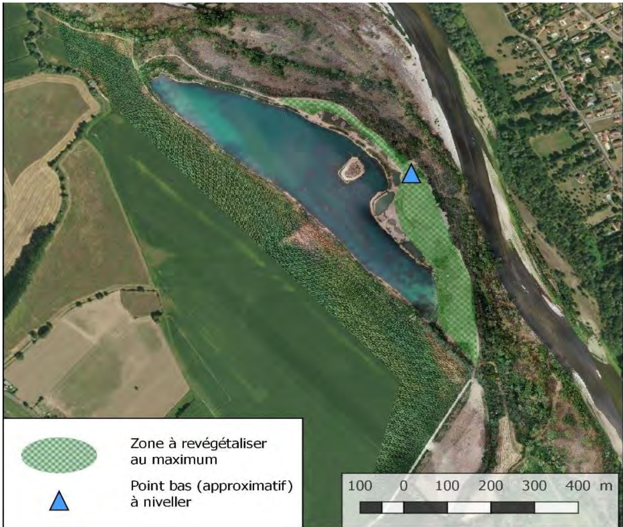
Synthèse des aménagements à intégrer au projet de réhabilitation final (source : HYDRATEC, 2019)
