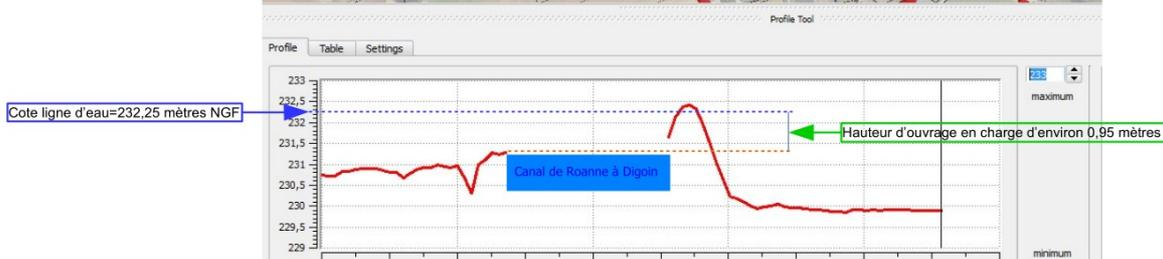
En fin de page précédente, le profil en travers dressé à partir du Modèle Numérique de Terrain et des isocotes reportées sur la carte de l'aléa inondation, met en évidence la valeur de montée en charge du talus situé en rive droite du Canal de Roanne à Digoin. Cette montée en charge serait de l'ordre de 0,95 mètres lors de la survenance d'une crue du type de celle de 1846.
