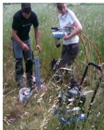
Test de résistance à l'arrachage des pieux
