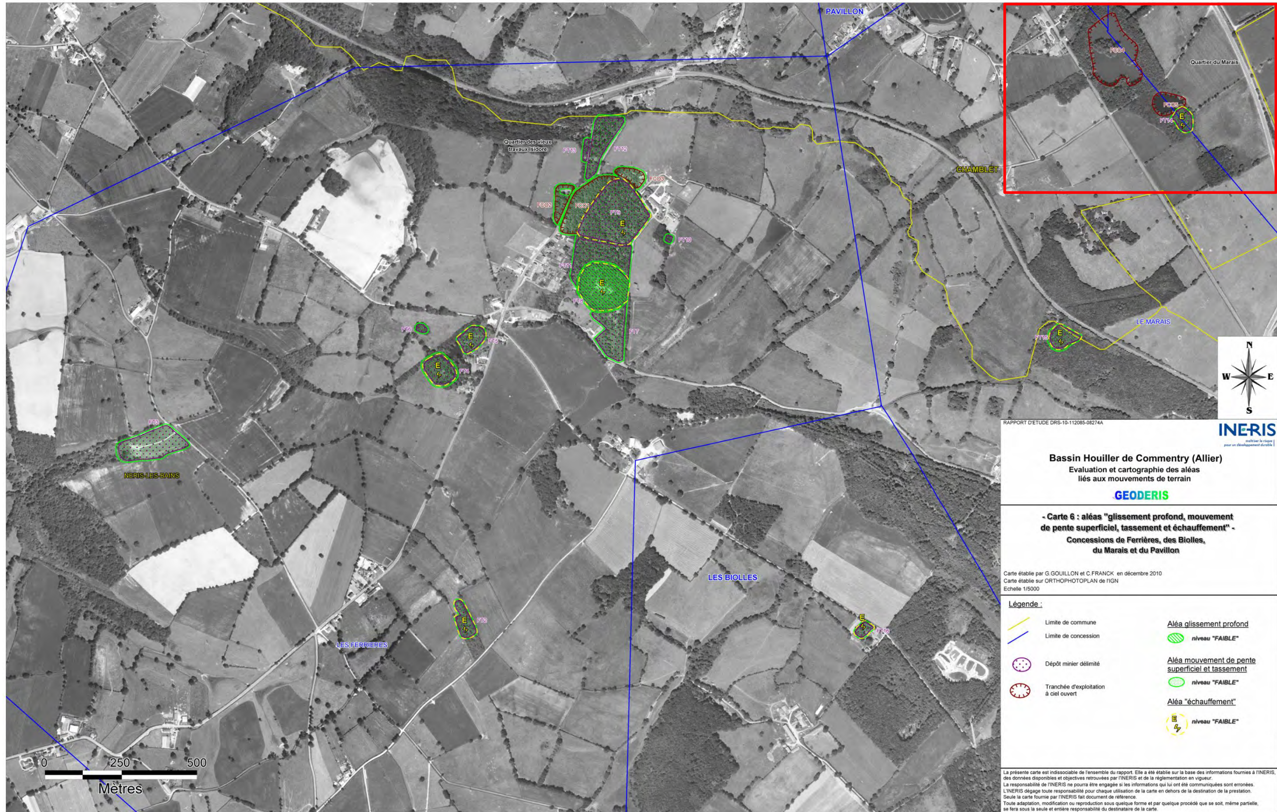
Extrait de la carte d'aléas « glissement profond, mouvement de pente superficiel, tassement et échauffement » - Source : Géoderis
