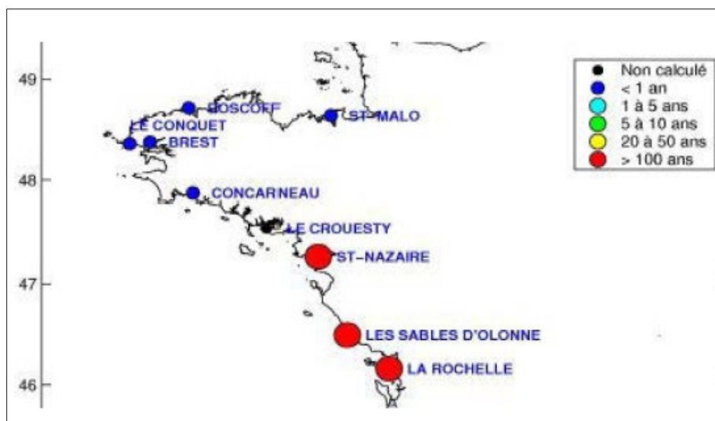
Figure 2 - Estimation des périodes de retour des hauteurs de pleine mer durant la tempête Xynthia de février 2010 (SHOM)
